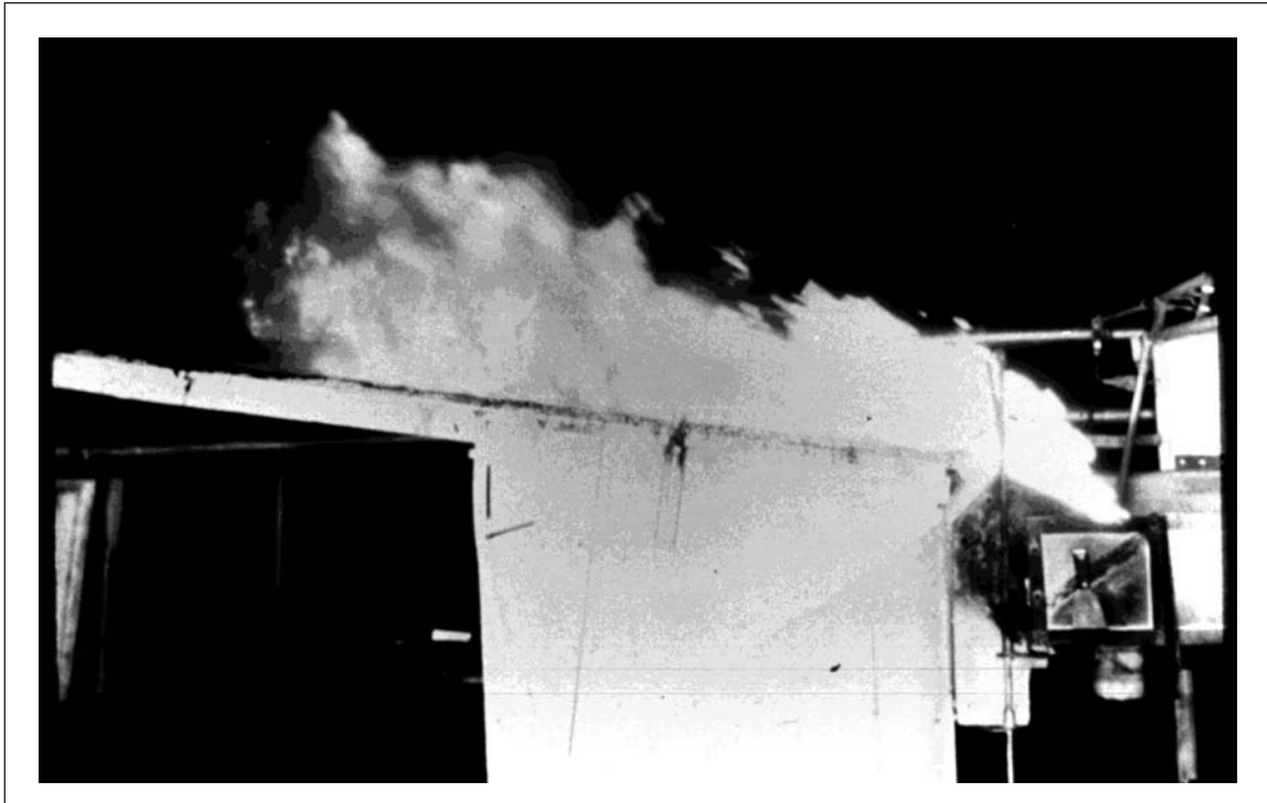
Fig. 5. ASTM E108 spread of flame test
